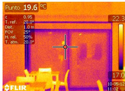
Figura 95. Termografía de un hueco
