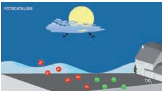
La fotocatalisis es una reacción fotoquímica que involucra la absorción de luz ultravioleta por parte de un catalizador.
