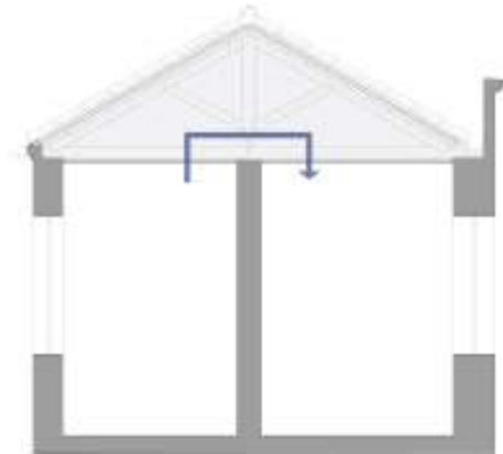
Figura IV.2.10. En azul transmisión aérea indirecta a través de la cámara de aire en el techo de dos viviendas. Este tipo de transmisión puede ser habitual en la última planta de viviendas con estructura de madera en la cubierta, en las que sólo hay un falso techo que separa los recintos de la cámara de la cubierta.
