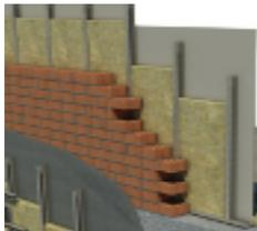
Sistema de aislamiento térmico y acústico de fachadas mediante placas de yeso laminado (PYL), montadas sobre un armazón metálico asociado a los paneles de lana mineral.
