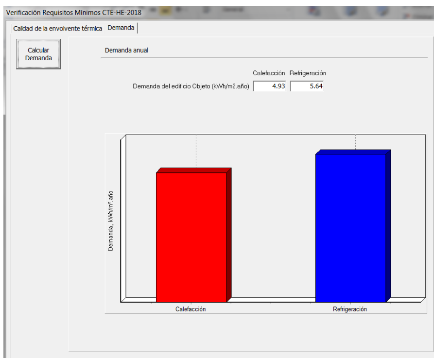
Figura 16: Necesidades energéticas para el edificio con recuperador de calor
