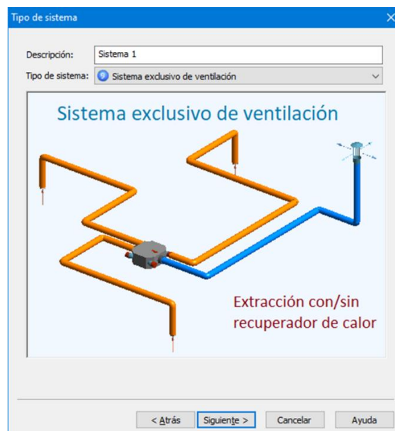
Ilustración 52. Selección de sistema de tipo ventilación exclusivo.
